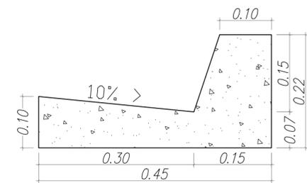
**GUIA COM SARJETA SEM ESCALA**
