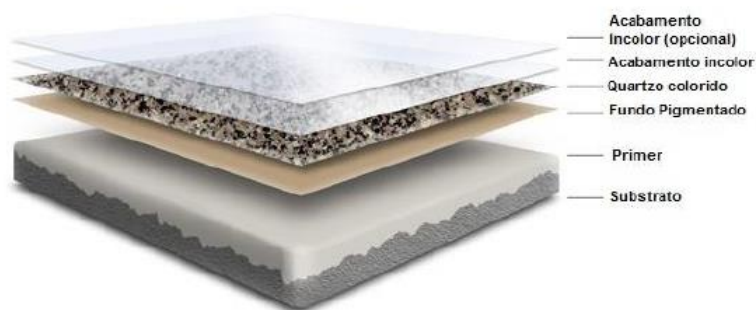
Ilustração das camadas do piso em quartzo
