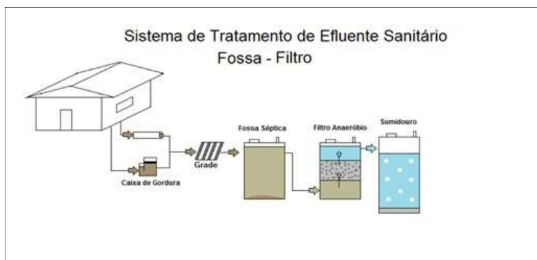
Figura 1. Sistema Compacto de Tratamento de Efluente Sanitário Fossa-Filtro.
