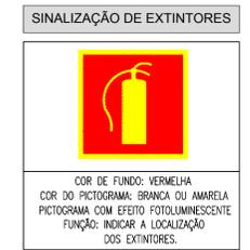
OBSERVAÇÃO: A SINALIZAÇÃO DE SOLO SERÁ PREVISTA QUANDO O EXTINTOR FOR INSTALADO EM GARAGEM, ÁREA DE FABRICAÇÃO, DEPOSITO E LOCALS UTILIZADOS PARA MOVIMENTAÇÃO DE MERCADORIAS E DE GRANDE VAREJO.
