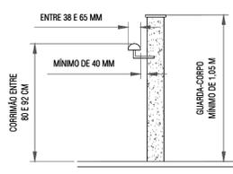
DETALHE 2 - GUARDA CORPO E FIXAÇÃO DOS CORRIMÕES
