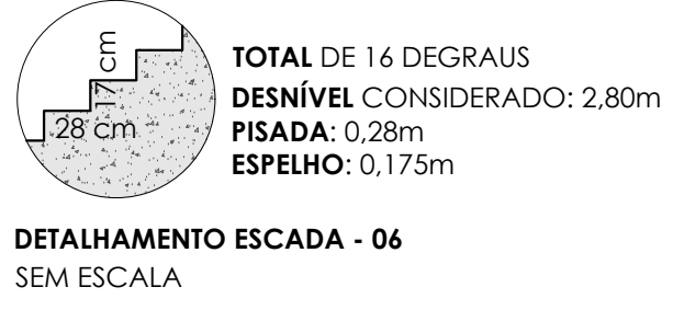
DETALHAMENTO ESCADA - 06 SEM ESCALA
