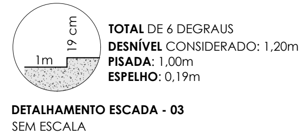
DETALHAMENTO ESCADA - 03 SEM ESCALA
